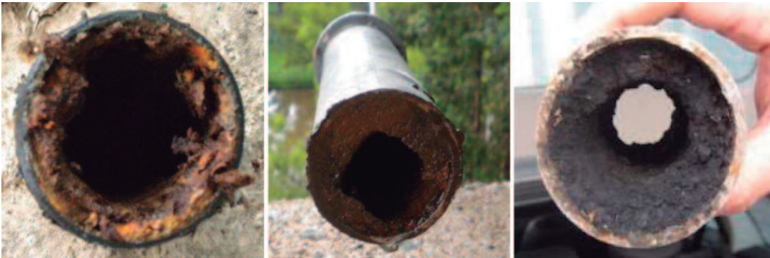
Imágenes que muestran la sección transversal de tuberías que contienen biofilm.
